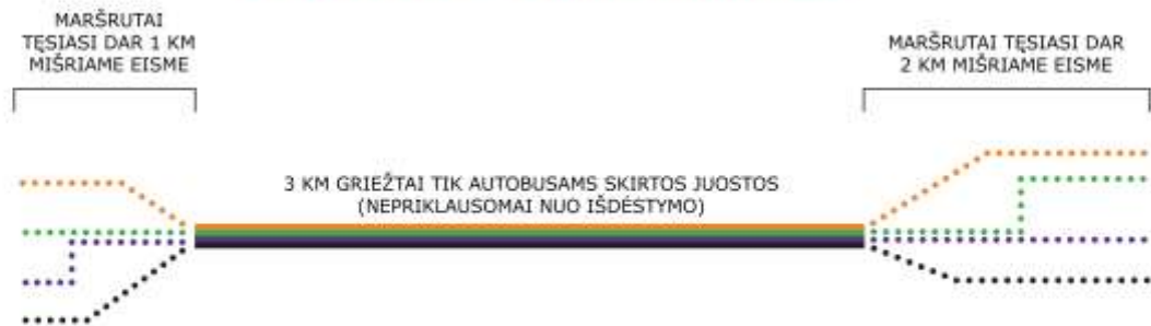
PAV. 94 BRT KORIDORIAUS ATITIKIMO BRT STANDARTUI PAVYZDŽIAI (ITDP, 2014)
